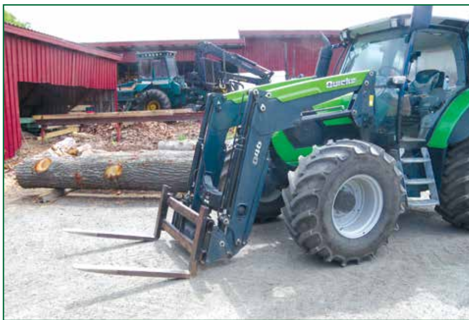
LØFTEKRAFT: Lassbæreren er bra til å flytte tømmer, legge stokker til rette på bandsaga og laste opp på inntaket. Inntaket på sirkelsaga har litt fall inn mot sagbenken. Stor traktor med pallegaffer er godt egnet til å flytte trelastpakker fra saga og til tørkeplass ute, den nye tørka, eller videre til høvel.
